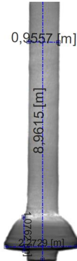
Figura 2: Leitura computadorizada das dimensões e verticalidade da escavação
